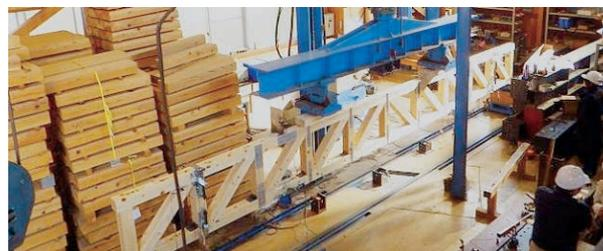
図8 斜材は圧縮・めり込みに効かず
