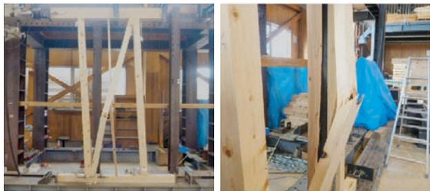
図4 筋かいは節で座屈破壊する
